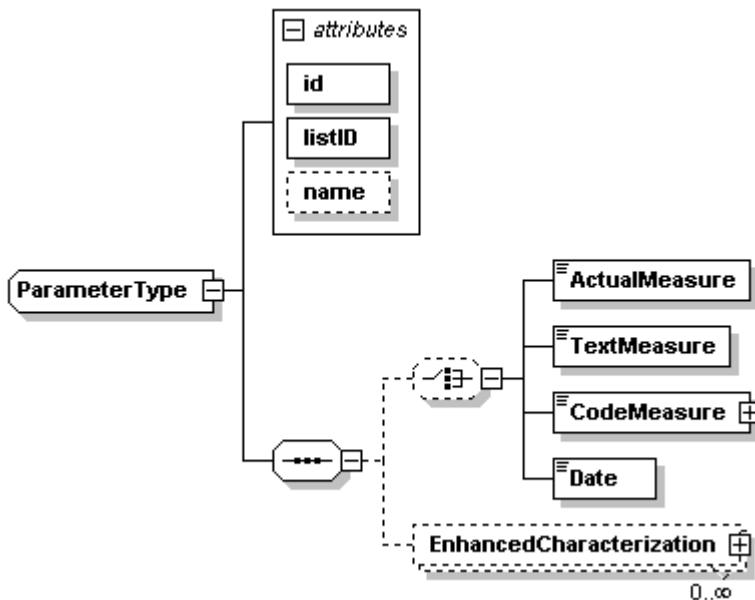
Datentyp für einen konkreten Messwert der Probe. Der eigentliche **Parameter** des Messwerts (z. B. „Nitrat“) wird durch die Attribute **id** und **listID** bestimmt. Das Attribut **listID** stellt die Kennung der Referenzliste für die Untersuchungsparameter dar, das Attribut **id** stellt die ID des Parameters in dieser Referenzliste dar.
