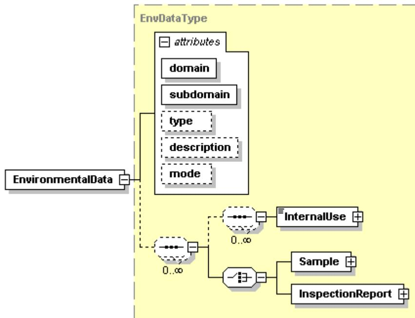
Das Element **EnvironmentalData** bildet das Wurzelement des XML-Dokuments.
