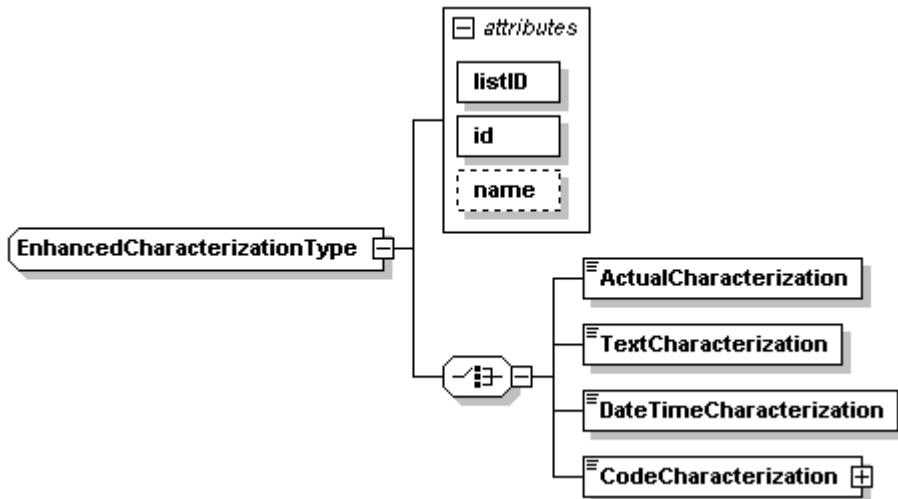
Datentyp für die erweiterte Charakterisierung von Inspektionsberichten, Ortsbefunden, Proben und Messwerten. Dieses Konstrukt erlaubt es, auf verschiedenen Ebenen des XML-Dokuments strukturiert zusätzliche Informationen zu erfassen.
